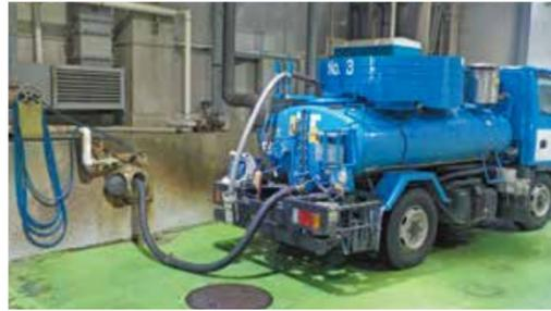
環境グリーンセンターは、各家庭から収集し搬入された、し尿及び浄化槽汚泥を、無色透明な処理水にし、消毒を行い、川へ安全に放流できるように処理をしています。また、汚泥は脱水処理を行い、清掃センターで焼却処理をしています。
