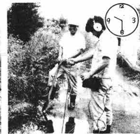
午前9時30分 ジャリ道に水たまりを発見。漏水箇所だ！漏水探知器で確認する。
