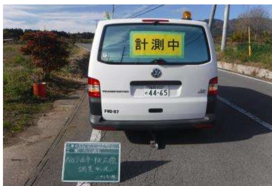
写真-1.1 FWD調査
