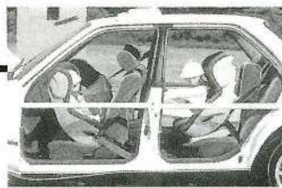
時速50kmで走る乗用車同士の衝突実験の瞬間。チャイルドシートによって、子どもは衝撃から守られている。
